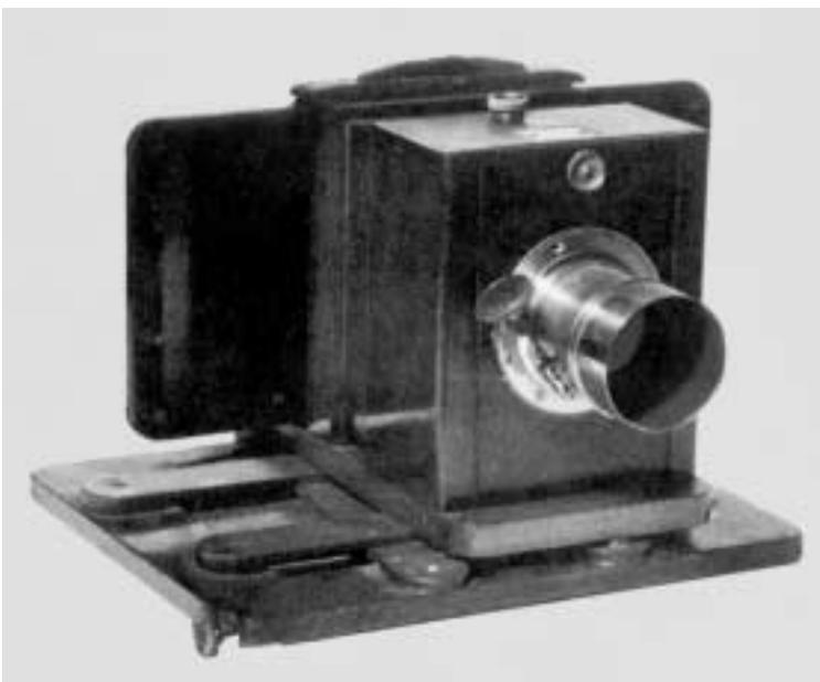
*Abb. 13: Kamera mit Vorrichtung zur Aufnahme stereoskopischer Bilder, 1857. Zur Aufnahme des zweiten Bildes kann die Kamera um den notwendigen Abstand in der gleichen Ebene verschoben werden. Durch den zeitlichen Abstand der beiden Aufnahmen ist sie nur für unbewegte Objekte geeignet.*
