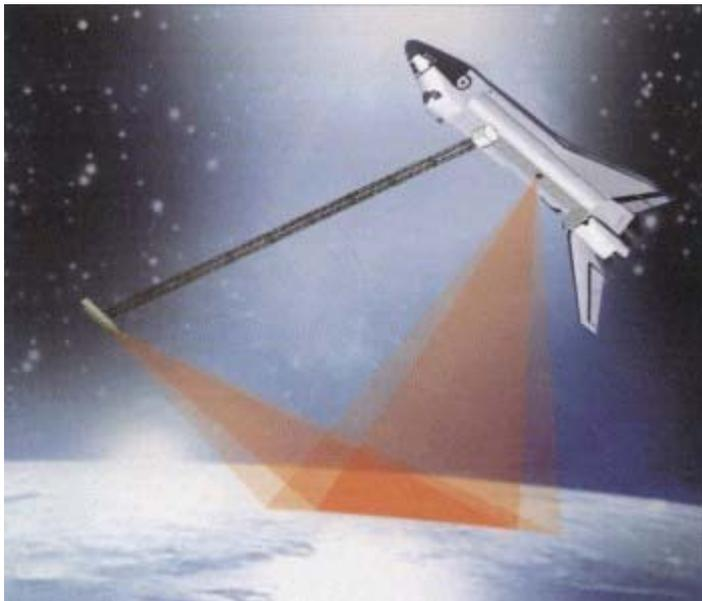
An Bord waren zwei interferometrische Radarsysteme, die verschiedene Wellenlängenbereiche nutzten: Das amerikanische C-Band Radar arbeitete im Wellenlängenbereich von 5,6 Zentimeter. Das deutsch-italienische X-Band System (X-SAR) zeichnete Daten im Bereich von 3,1 Zentimeter Wellenlänge auf. Bedingt durch seine geringere Streifenbreite konnte mit dem X-Band-Radar keine vollständige Abdeckung erreicht werden. Die vertikale Genauigkeit der Höhenmodelle ist dafür bei den X-Band-Daten annähernd
