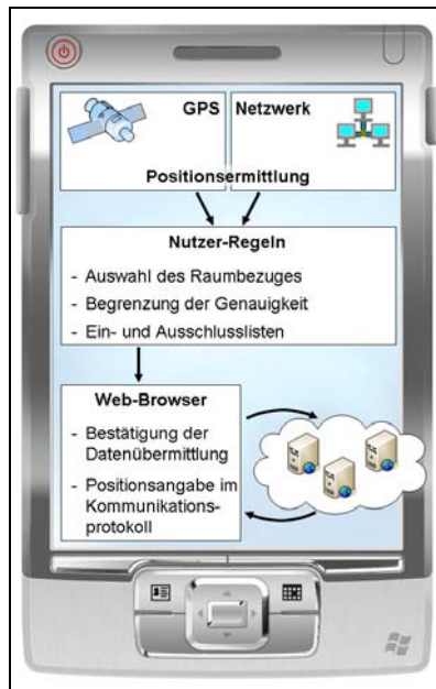
Abbildung 201: Schema zu Verwendung von Positionsinformationen im Web
