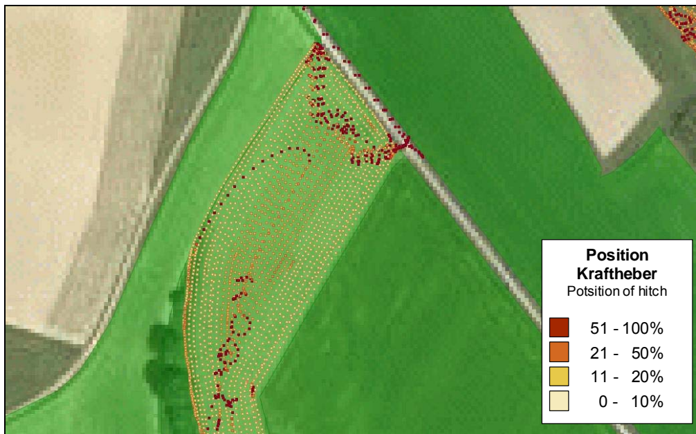
Abbildung 137: Daten des ISOBUS-TaskControllers visualisiert mit Hilfe eines GIS Figure 137: Data of an ISOBUS-TaskController in a GIS
