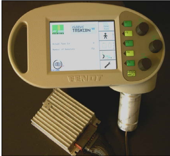
Abbildung 136: Prototyp eines ISOBUS-TaskControllers mit CPU und Darstellung auf einem Virtual Terminal Figure 136: Prototyp of an ISOBUS-TaskController with CPU and graphical user interface on a virtual terminal
