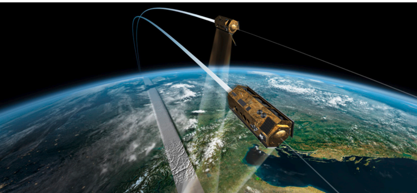
Die Radarsatelliten TerraSAR-X und TanDEM-X fliegen in enger Formation und erreichen gemeinsam eine besondere Leistungsfähigkeit.
