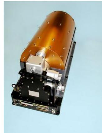
**Bild 70: Rubidium- und Wasserstoff-Maser Atomuhren**
