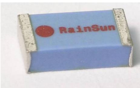
**Bild 153: Chip-Antenne**
