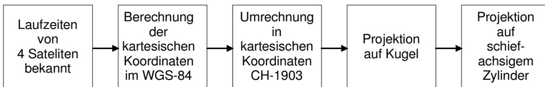
**Bild 24: Vom Satelliten bis zur Position**
