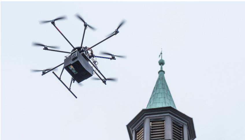
**Abb. 1:** Messsystem des Fraunhofer IPM, ausgestattet mit zwei RGB-Kameras und einem Laserscanner. Das Messsystem ohne Drohne wiegt 2,5 kg.
