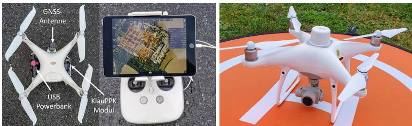
**Abb. 3: DJI Phantom 4 Pro V2.0 KlauPPK (links) und Phantom 4 RTK (rechts)**
