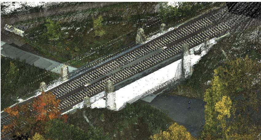
Abb. 7: Kolorierter Laserscan einer Eisenbahnbrücke mit dem LAP-System
