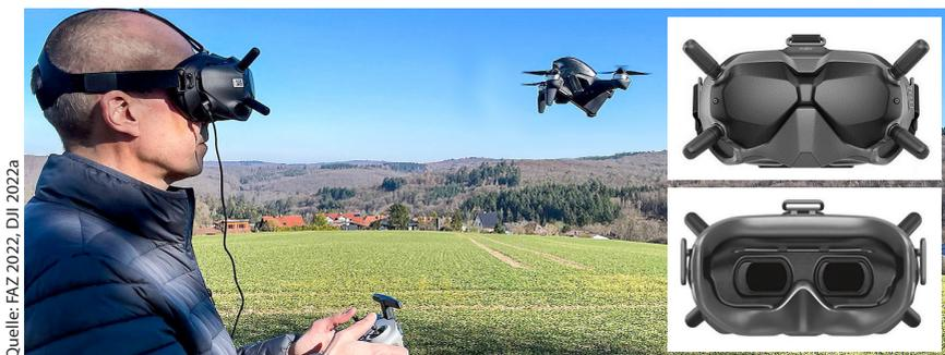
Abb. 4: Steuerung des UAV mittels FPV
