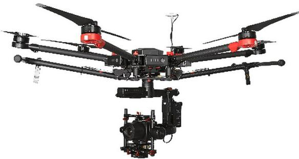
Abb. 1: Beispiel DJI M600 Pro, Phaseone Setup
