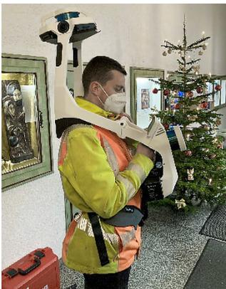
Abb. 4: Datenerfassung mit NavVis VLX
