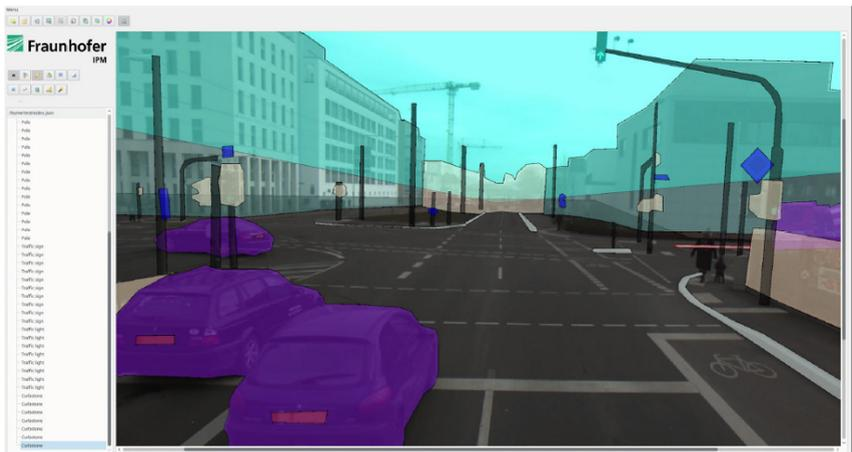
Abb. 4: Annotations-Tool von Fraunhofer IPM, welches das Annotieren komplexer Daten erleichtert. Die Bilddaten werden durch die Annotation farblich überlagert (in diesem Beispiel steht Violett für Fahrzeug); auf der linken Seite sind entsprechende Steuereinheiten aufgelistet, um die Klassen zuzuordnen.
