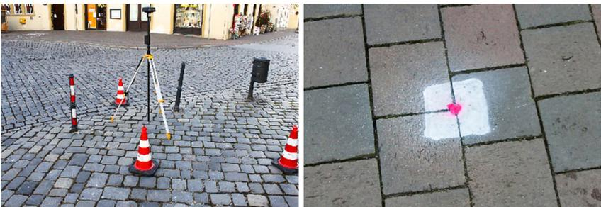
Abb. 6: Dem Projekt angemessen: Beispiele zur Passpunktmessung und Markierung
