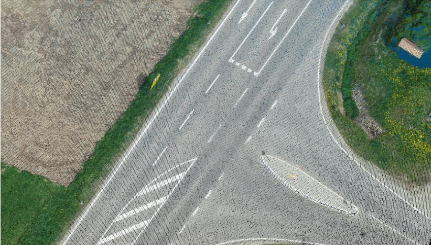
**Abb. 2:** Punktwolke einer Straßenszene, aufgenommen durch ein Messsystem, welches auf einer Drohne montiert war.
