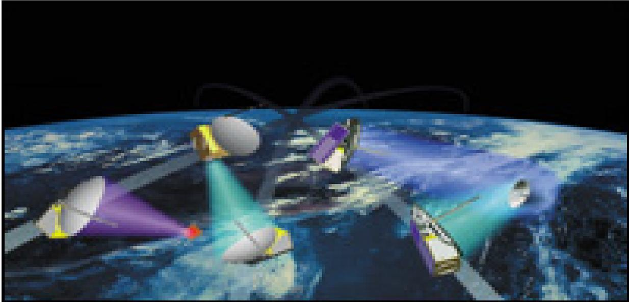
Bild 7: SAR-Lupe ist ein Radar-Allwetter-Aufklärungssystem für die Bundeswehr, das aus fünf Kleinsatelliten und einem entsprechenden Bodensegment zur Satellitenkontrolle sowie zum Empfang, zur Verarbeitung und Auswertung der Bilddaten besteht.
