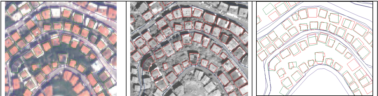
Abbildung 7: Kartierung von Gebäuden mit QuickBird Farbaufnahmen (2,4m Objektpixelgröße) und QuickBird panchromatischen Aufnahmen (0,62m Objektpixelgröße) rechts: Überlagerung
