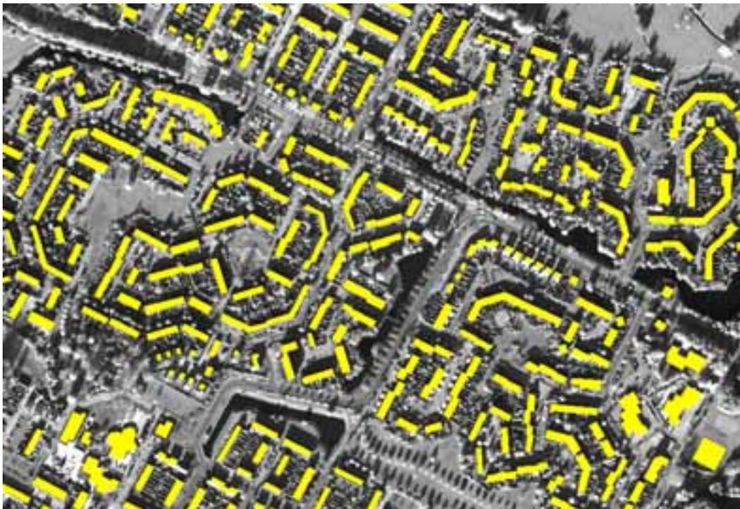
Abb. 83 zeigt die Überlagerung dieser rasterisierten Hausdaten mit dem Bilddatensatz.Nadirbild und überlagerter Vektordatensatz, Vektordaten wurden rasterisiert
