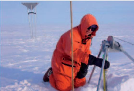
Eine Neutronensonde wird in einer Bohrung im Eis versenkt. Sie erfasst wichtige Informationen über die Dichte von Schnee- und Eisschichten, die zur Interpretation der Beobachtungen des Radarhöhenmessers und letztendlich zum Erreichen des Hauptziels der CryoSat-Mission über Landeis beitragen - der Ableitung von Massenbilanzen aus den Höhendaten. (Norwegisches Polarinstitut)
