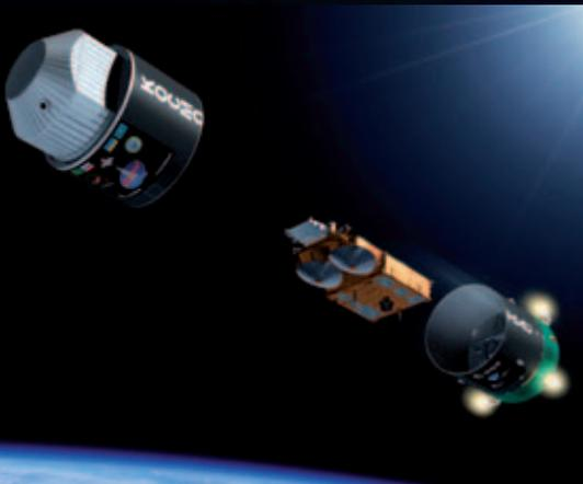
CryoSat-2 wird mit einer Dnepr-Trägerrakete ins All befördert. Unüblicherweise fliegt die Oberstufe bis zum Aussetzen des Satelliten rückwärts. Dies erhöht die Genauigkeit bei der Einbringung in die Umlaufbahn. Der Start erfolgt vom Raumfahrtzentrum Baikonur in Kasachstan. (ESA/P. Carril)
