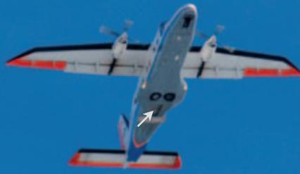
Ein mit AIRAS - der Flugzeugvariante des Radarhöhenmessers an Bord von CryoSat - bestücktes Flugzeug vom Typ Dornier-228 des Alfred-Wegener-Instituts. Unter dem Rumpf ist die rechteckige Antenne erkennbar. Zusammen mit einem Laserscanner liefert sie die für die Validierung der CryoSat-Daten erforderlichen Messwerte. (ESA/M. Davidson)
