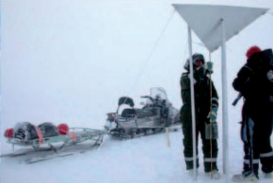
Sogenannte Corner- oder Winkelreflektoren wurden während der Validierungskampagnen für CryoSat intensiv genutzt. Es handelt sich um Metallkonstruktionen, welche die Radarstrahlen des flugzeuggetragenen ASIRAS instruments mit definierter Stärke reflektieren. Dadurch helfen sie bei der Analyse der Qualität des Radarsignals und der Eindringtiefe des Signals in Schnee- und Eisflächen. (Norwegian Polar Institute)
