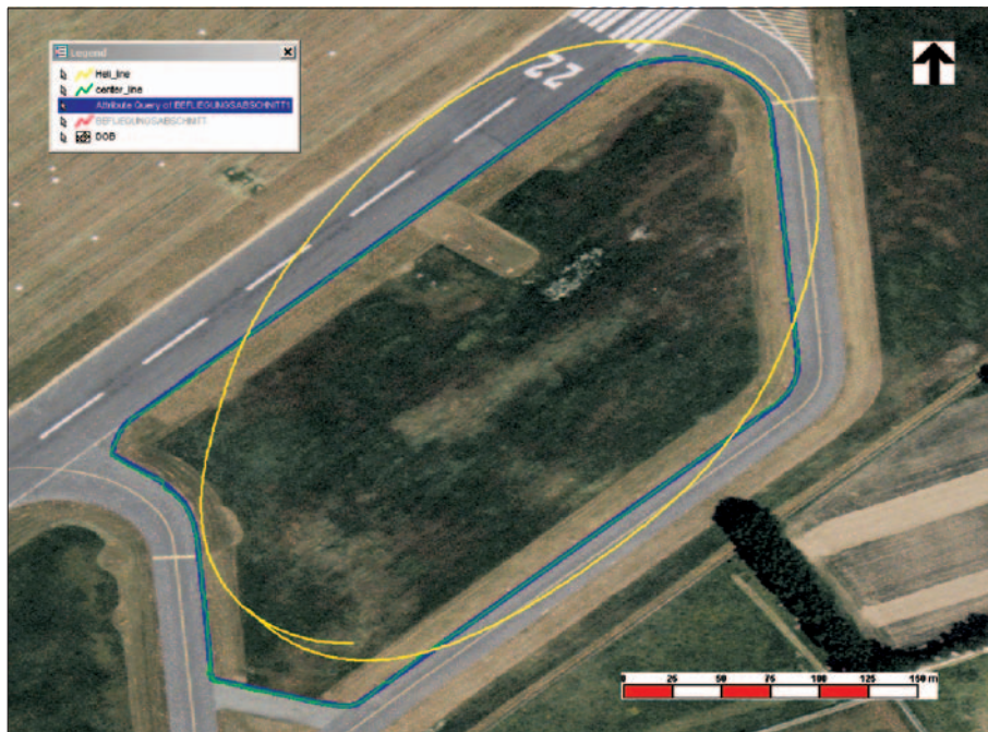
Bild 4: Darstellung der Ergebnisse zum Nachweis der Präzision der Laserstrahlausrichtung. Blaue Linie: Verlauf der Testleitung, gelbe Linie: Flugbahn des Hubschraubers, grüne Linie: Mittelpunkte der Scankreise. Grüne und blaue Linie liegen innerhalb von \pm 1,5 m aufeinander
