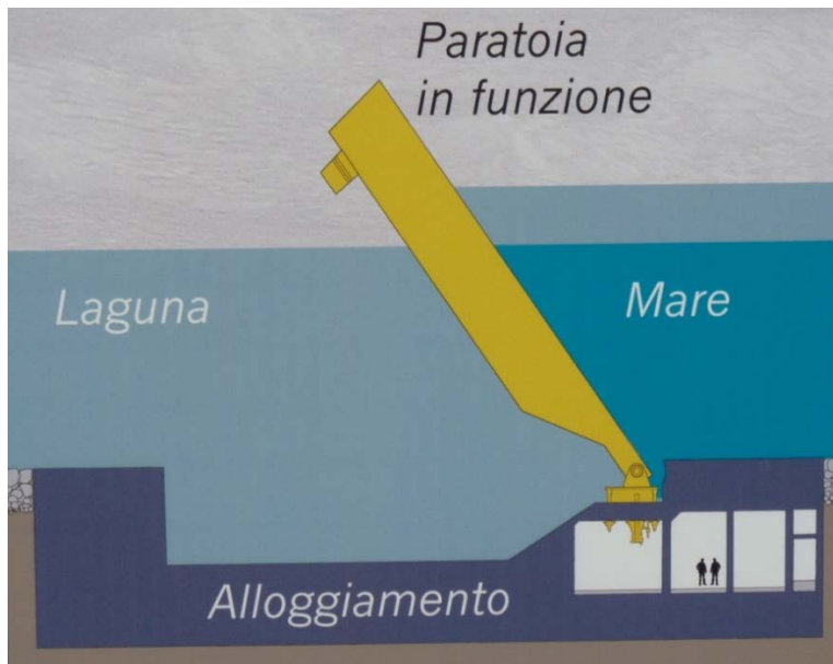
Abb.2: Hochwasserschutztor im Querschnitt (Foto Y. Schleicher)
