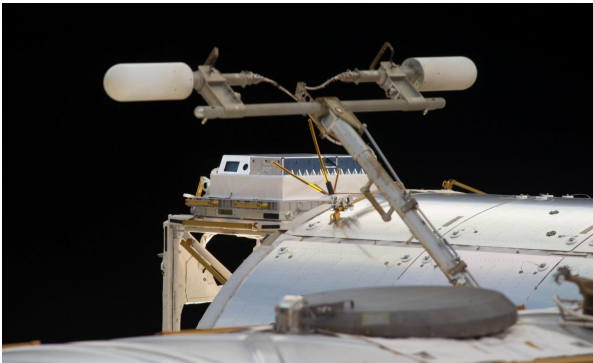
Abb. 3: Box mit den vier COTS-Kameras (Hintergrund) an der Außenseite des europäischen Columbus-Raumlabors (runder Korpus)
