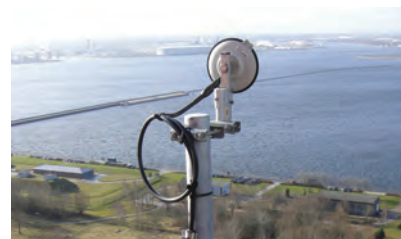
Eines von sechs Pseudolites von SEA GATE (Foto: EADS-RST).
