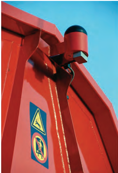
Mehr als 13 000 Güterwagen der DB Schenker Rail sind mit autonom arbeitenden GPS-Anlagen ausgerüstet (Foto: DB Schenker Rail).
